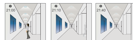
La lumière s'allume à 100% lorsqu'un mouvement est détecté. La lumière passe au niveau de veille après le temps de maintien. La lumière reste au niveau de gradation la nuit.
