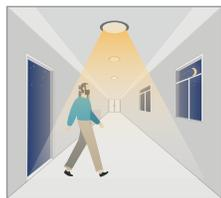
Si la lumière du jour est insuffisante, le capteur allume la lumière lorsque le mouvement est détecté.
