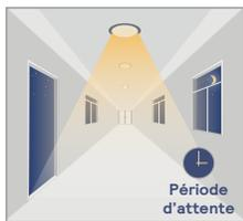
Après le temps de rétention, le capteur atténue la lumière jusqu'au niveau de gradation en attente s'il ne détecte plus de mouvement.
