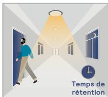
Lorsqu'il n'y a plus de mouvement, le capteur garde la lumière à 100% pendant le temps de rétention.
