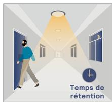
Le capteur maintient un temps de rétention lorsque le mouvement s'arrête.
