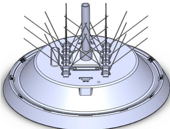
L'option de pointes de dissuasion des oiseaux sont principalement utilisée pour les installations pendantes. Un découpage supplémentaire de la bande peut être requis. Le pliage des broches individuelles peut-être requis pour recouvrir les zones plates ou les oiseaux sont susceptibles d'installer leur nid
