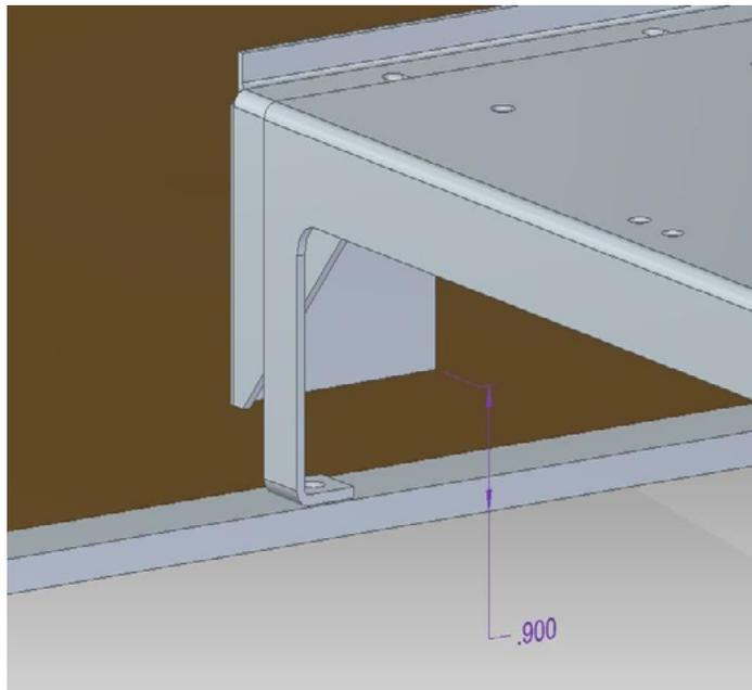
NOTE : afin que le luminaire affleure le plafond il est important que les supports latéraux adjacents au support de montage soient soulevés pour que le dessous du support repose à 9/10 po du côté de la pièce du plafond.
